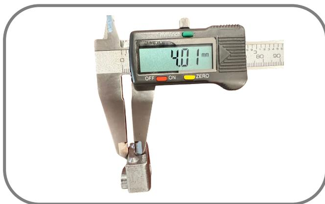
Altezza del nottolino (escluse sporgenze) \_\_\_\_\_ mm
